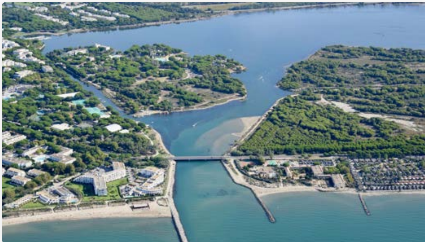
On peut voir l'ensablement à l'entrée de la passe des Abîmes entre La Grande-Motte et Le Grau du Roi. - Les Amis et riverains du Ponant
